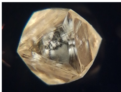
Рис. 3. Двупреломление, обусловленное плоскостью скольжения в образце А11
