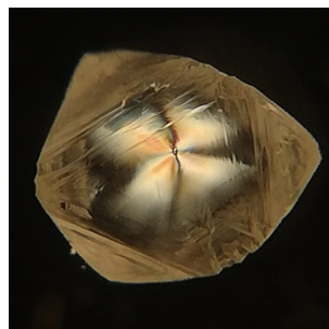
Рис. 4. Двупреломление, вызванное темными включениями в образце М11.2.
