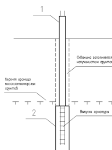
Рис. 1 – Сборно-монолитная свая: 1 – сборная часть с арматурными выпусками; 2 – монолитная часть
