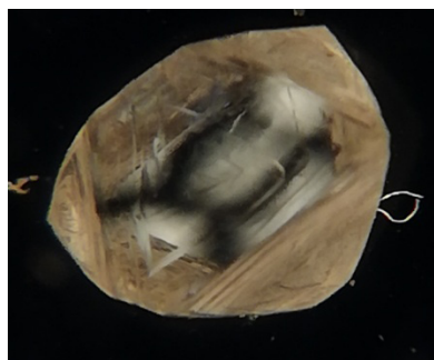
Рис. 1 – Двупреломление в виде фантома, вызванное объемным напряжением в образце М10.2.
