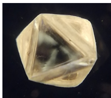
Рис. 2 – Двупреломление, связанное с внешними динамическими нагрузками, в образце М2
