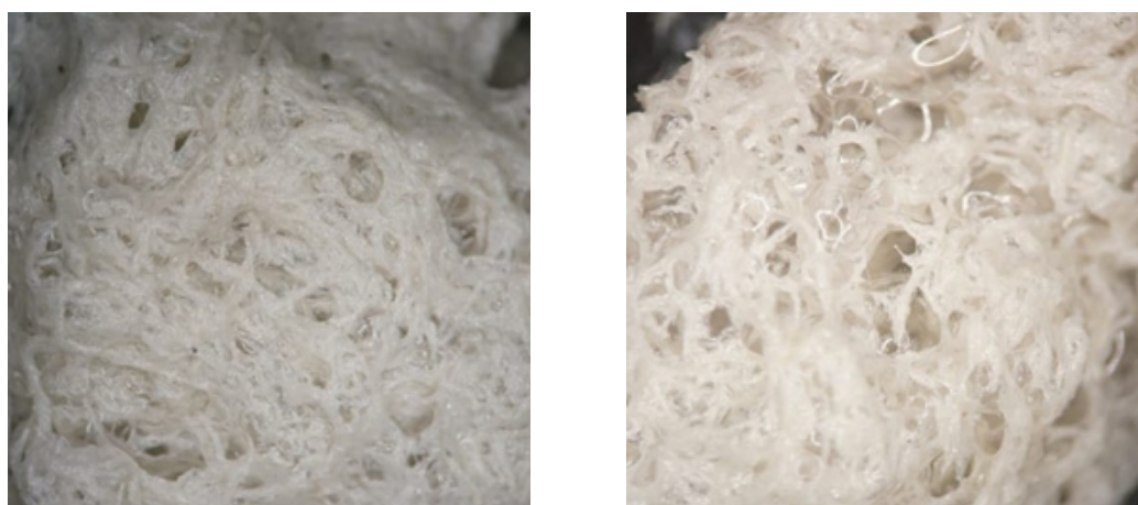
Рис 1 – Микроструктура асбеста марки 3-60 и 4-30 в пене, приближение в 10 раз
